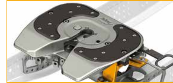
Klar gewichtsoptimiert: Die Integration der Sattelkupplungen in den Fahrzeugrahmen senkt deutlich das Eigengewicht der Zugmaschine.
